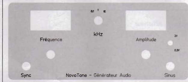
Figure 12 : Face avant, découpes et sérigraphie
