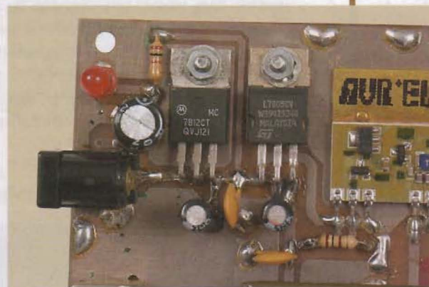
Le cuivre sert de dissipateur thermique aux deux régulateurs
