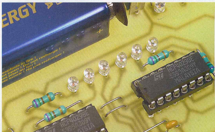
Des diodes LED signalent l'état binaire des sorties Q des compteurs GD4029
