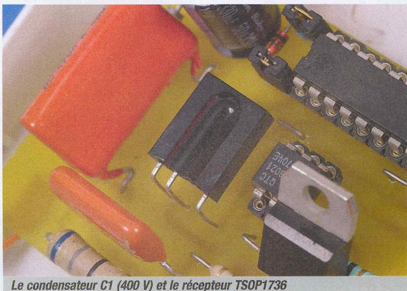
Le condensateur C1 (400 V) et le récepteur TSOP1736
