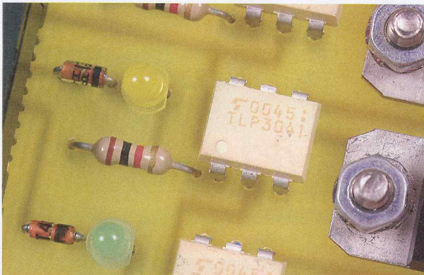
Isolation galvanique par optocoupleurs
