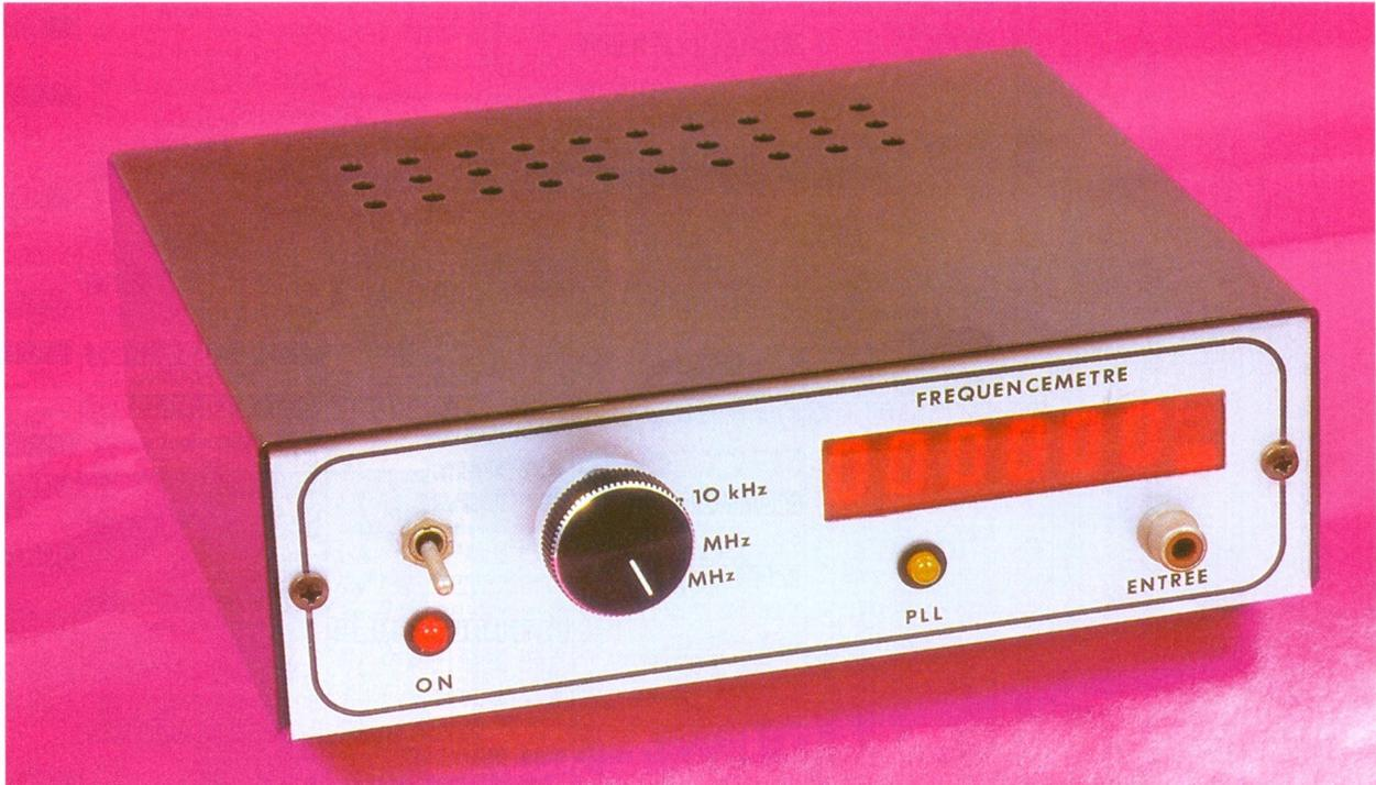
**Nous vous proposons de réaliser un fréquencesmètre de table destiné plus particulièrement à la mesure des basses et moyennes fréquences, soit de 0,1 Hz à 10 MHz. Dans tous les cas, le temps de mesure sera de 1 seconde et la précision relative meilleure que 2 ppm. De plus, ce montage ne fait appel qu'à des composants courants et reste très compact.**
