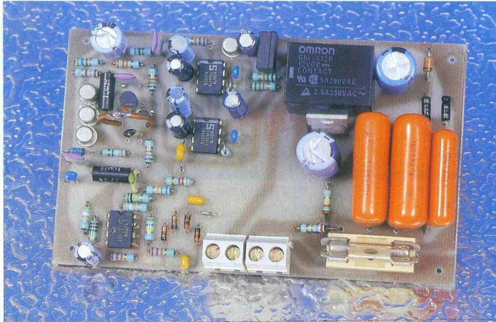
potentiomètres. Ainsi, lorsque l'onde porteuse est accordée sur le canal du récepteur, tout signal audio est alors détectable mais seul un spectre de fréquence est retenu grâce à un décodeur de tonalité NE567. Le calage en fréquence du décodeur s'effectue par un jeu de résistances standards dont la formule est :
