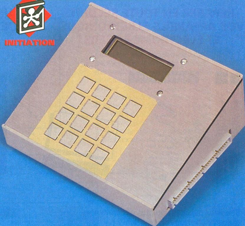
Afin de rendre le module de base plus attrayant, nous vous proposons ce mois-ci de réaliser un module avec un afficheur LCD et un clavier. Ce module pourra servir à tous les modules d'extension que nous décrivons, y compris le module 64 I/O.
