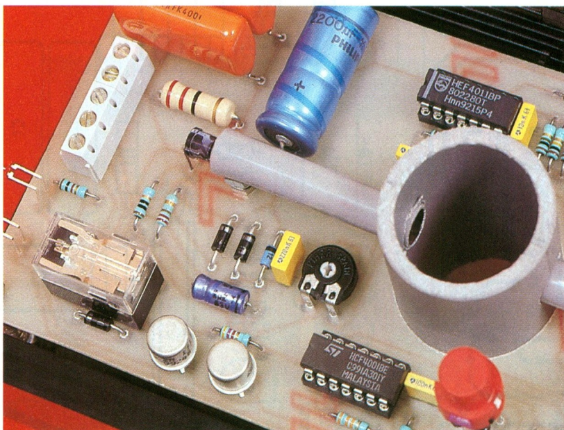
Le Relais de sortie active un dispositif d'alarme.
