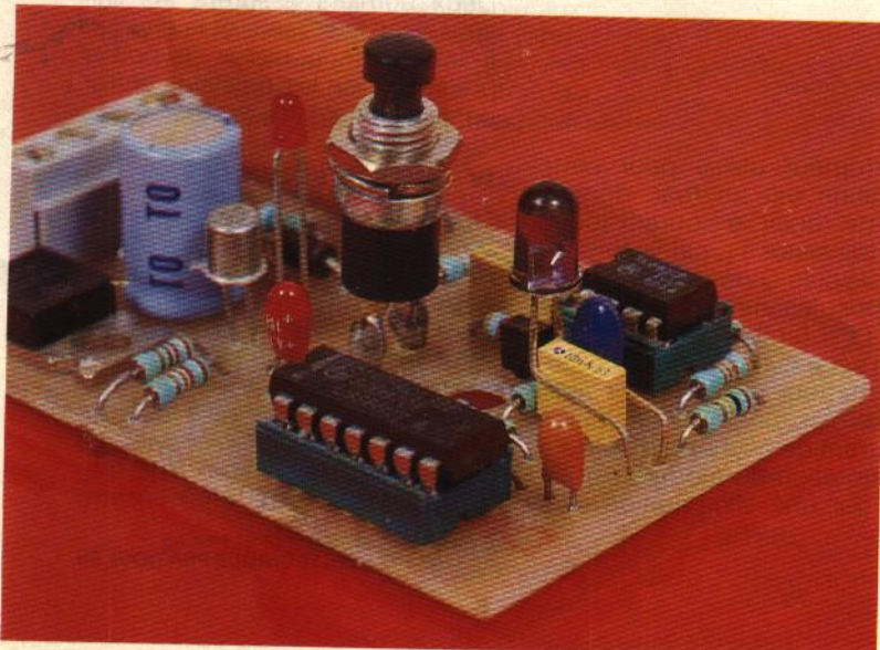
◀ Photo 3. - Le phototransistor capte le rayonnement IR du boîtier de télécommande. Photo 2. - Le bornier autorise le raccordement au secteur et à la charge. ▼
