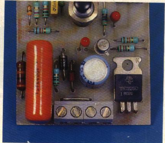
◀ Photo 3. - Le phototransistor capte le rayonnement IR du boîtier de télécommande. Photo 2. - Le bornier autorise le raccordement au secteur et à la charge. ▼
