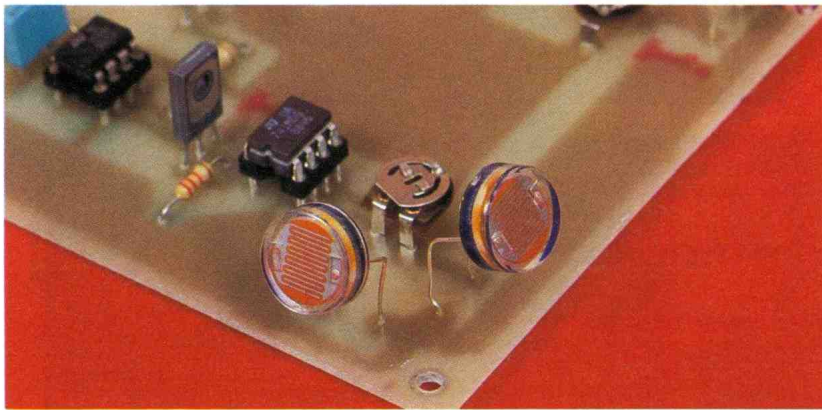
Photo 4. — Les résistances LDR actionnent les amplificateurs opérationnels pour les changements de direction.
