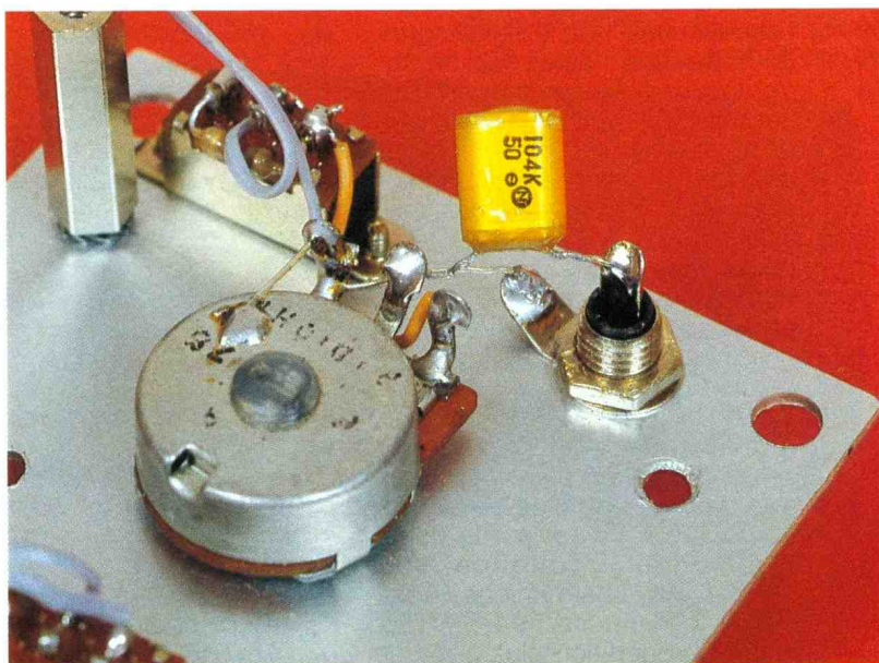
Photo 3. - La résistance R_{11} et le condensateur C_9 sont câblés sur la face avant.
