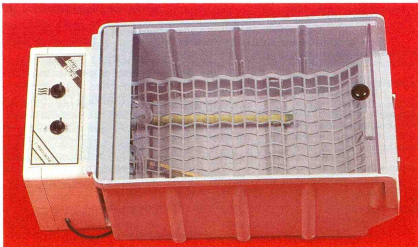
Photo 4. - Le bain de perchlorure Micrograv'.
