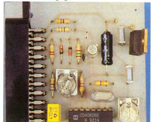
Photo 3. – Les deux résistances ajustables autorisent les réglages de niveaux.
