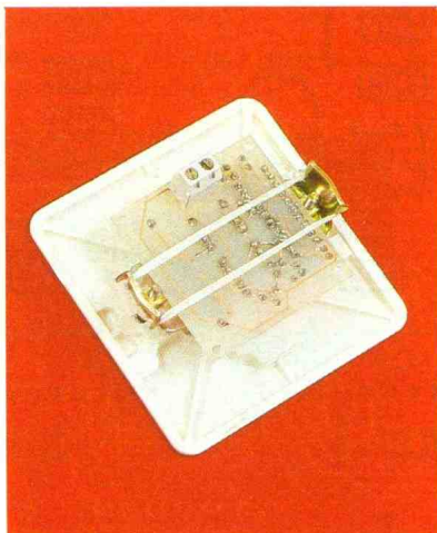
Photo 5. – L'émetteur se loge dans un boîtier encastrable.
