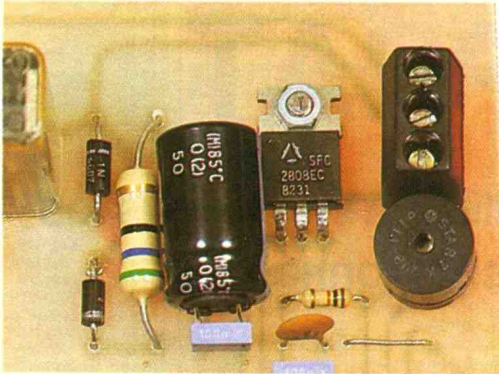
Photo 3. – Le bornier de sortie permet les branchements avec l'extérieur.
