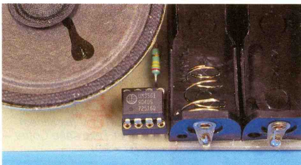
Photo 2. - Le support de pile est fixé par ses languettes au circuit imprimé.
