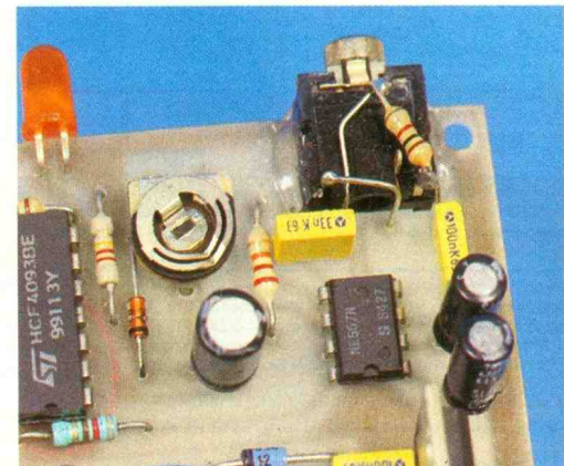
Photo 2. - La résistance R4 prend place sur le jack.
