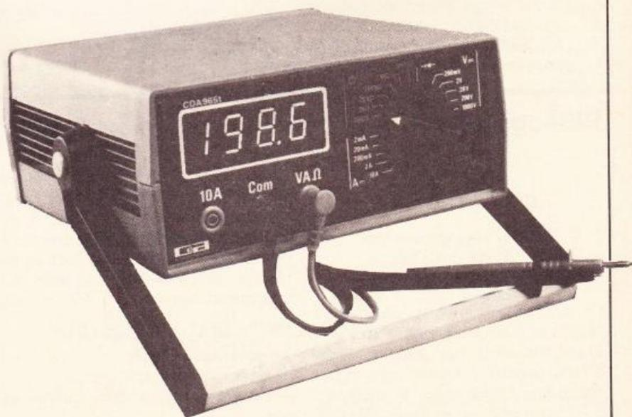
continu et en alternatif. Les diverses fonctions : voltmètre, ampèremètre, ohmmètre et test des jonctions semiconductrices, sont regroupées en zones que séparent clairement des sérigraphies en trois couleurs. Le commutateur commande la position du point décimal. Pour les mesures en continu, la polarité s'inscrit automatiquement. Enfin, en cas de dépassement, seul reste allumé le « 1 » de gauche.
