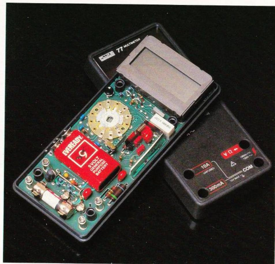
Photo 2. - Vue intérieure de l'appareil.
