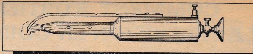
Lorsqu'on doit souder, par exemple, un robinet de cuivre à un tuyau de plomb, il faut bien se garder de chauffer à la lampe au point de contact à égale distance des deux corps, parce que le cuivre soutire plus de chaleur que le plomb. Il faut chauffer uniquement le cuivre, autrement il ne montera pas et vous passerez au travers du plomb. (Décapant : la bougie).
