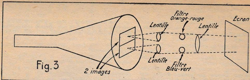
jours dû au génie inventif de Baird, les différentes images élémentaires sont produites côte à côte sur l'écran d'un oscillographe cathodique. Un système optique assez minutieux à réaliser mélange les images après filtrage (fig. 3).
