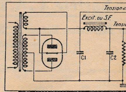
qu'un gain assez faible, on peut éviter l'inconvénient de supprimer la self de filtre, puisque la tension ronflée (compensée alternative) qui subsiste donne lieu à un léger courant dans la résistance de filtre. Le filtrage au moyen du condensateur (tête (entrée de filtre) est, dans la plupart des cas, suffisant pour maintenir le ronflement du secteur à un niveau acceptable.
