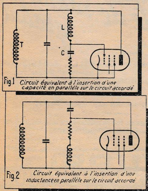
posons qu'un tube est branché dans un circuit accordé, comme celui de la figure ci-contre, offrant un effet équivalent à une capacité en parallèle. Le résultat que nous obtiendrons sera une fréquence de résonance inférieure sur le circuit accordé. Si nous utilisons le circuit représenté par notre schéma, l'effet produit est comparable à celui d'une inductance en parallèle, augmentant la fréquence. Dans les deux cas, l'effet d'inductance ou de capacité est variable.
