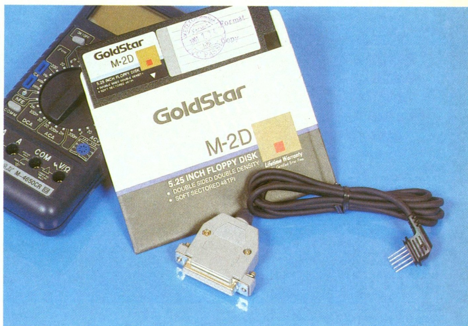
Photo 4. — La disquette livrée avec l'appareil fournit le programme pour mémoriser les données lues par le multimètre.
