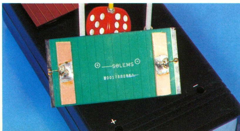
Photo 4. – Câblage du capteur photovoltaïque.
