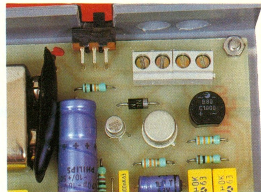
Photo 5. – Le bornier de sortie facilite la liaison avec la ligne téléphonique.
