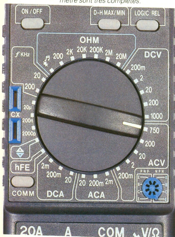
Photo 3. — Les fonctions de ce multimètre sont très complètes.
