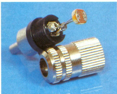
Photo 4. — Réalisation de la sonde avec sa LDR.
