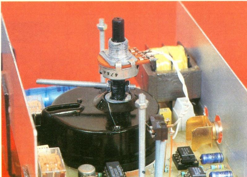
Photo 3. – Le moteur est asservi par un potentiomètre.
