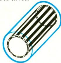
Moteur asynchrone à cage d'écureuil (alternatif)
