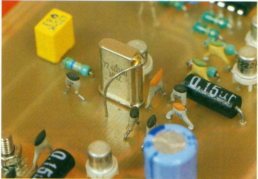
Photo 7. – Le boîtier du quartz d'émission rejoint la masse par un strap.
