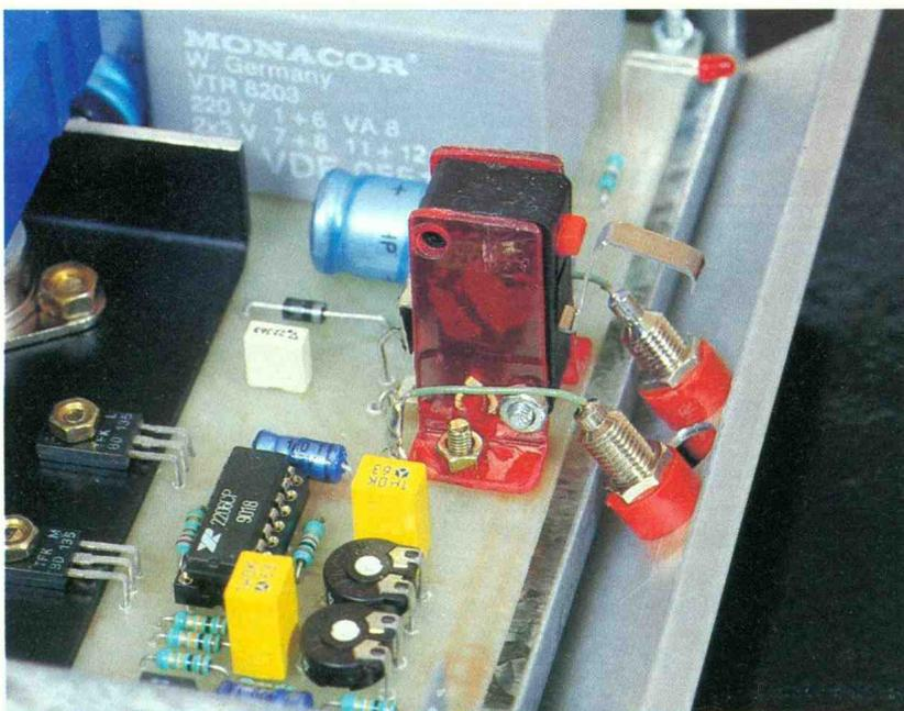
Photo 5. – Présentation du microcontact de mise en service.
