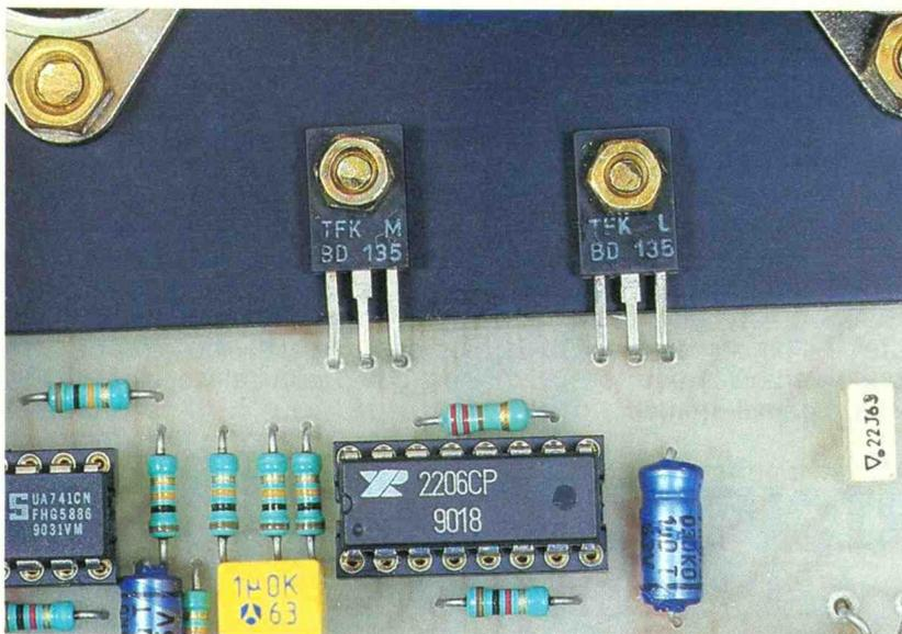
Photo 4. – Emplacement des transistors  $T_1$  et  $T_2$ .
