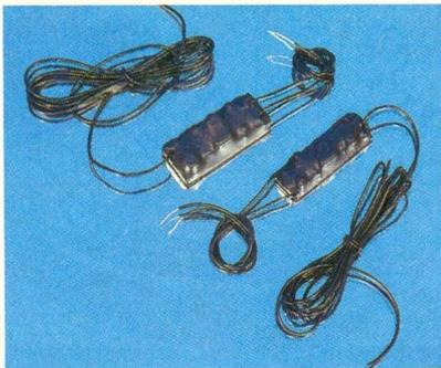
lithium. Les micros CR 297 et 296 se mettent en service lors d'une communication téléphonique grâce au courant de ligne, tandis que la version CR 282 comporte une mise en marche automatique dès que la parole apparaît, puis se coupe 10 secondes après la dernière syllabe. La gamme des fréquences sur lesquelles rayonnent ces trois micros HF de surveillance s'étend de 135 à 180 MHz, la modulation de l'onde s'effectue en FM. La réception s'opère donc sur un simple récepteur scanner du
