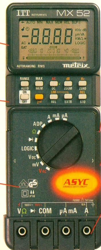
Compartiment pile/fusible étanche vers l'extérieur et vers les circuits internes, par membrane à joint torique (brevet METRIX).
