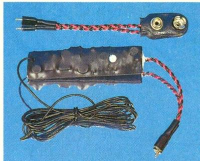
commerce ou par l'intermédiaire des modèles enregistreurs proposés par CRELEC, donc parfaitement adaptés pour l'usage. Les puissances développées à ces fréquences s'échelonnent de 60 à 100 mW, offrant ainsi des portées de l'ordre de 100 à 500 mètres en ville, mais jusqu'à 4 km à vue sans obstacles.
