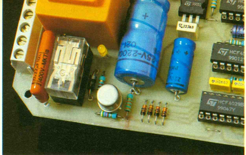
Photo 5. – Utilisation d'un relais 12 V/1 RT.
