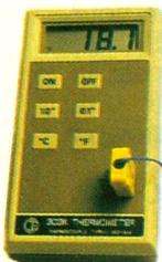
Thermomètre digital 3 digits 1/2. Avec sonde thermocouple K. Mesure de  $- 50^\circ$  à  $+ 1300^\circ \text{ C}$ . Résolution 0,1 $^\circ \text{ C}$  et 1 $^\circ \text{ C}$ . Précision 0,2%. Deux lectures  $^\circ \text{ C}$  et  $^\circ \text{ F}$ . Dim. : 130 x 72 x 83 mm
