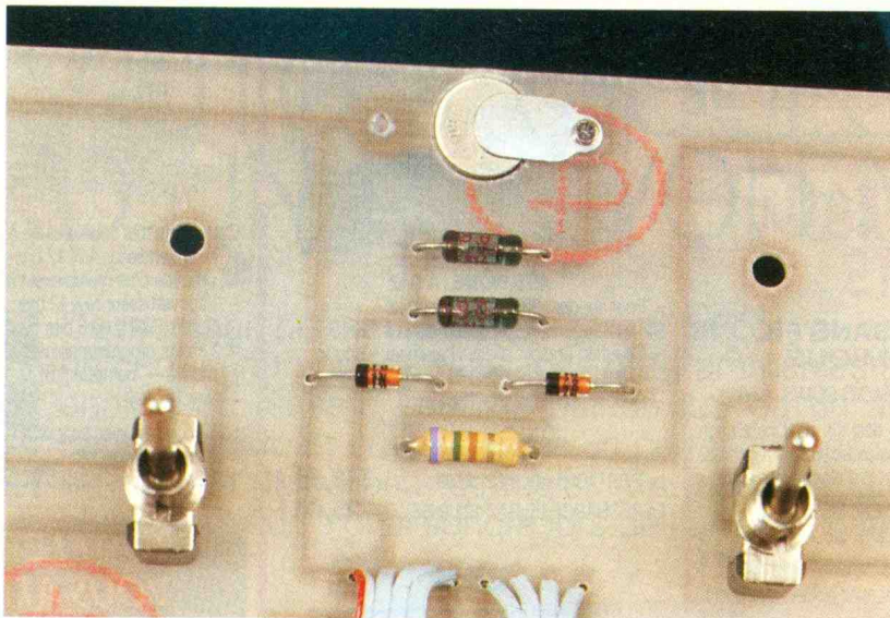
Photo 6. – Insertion de la pile bouton dans le circuit imprimé.
