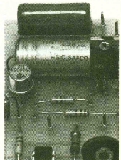
Photo 3. - Le 2N2905, un transistor fréquemment rencontré dans les montages d'E.P.
