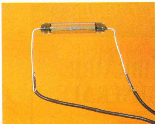
Photo 5. - La détection composée d'un ILS.
