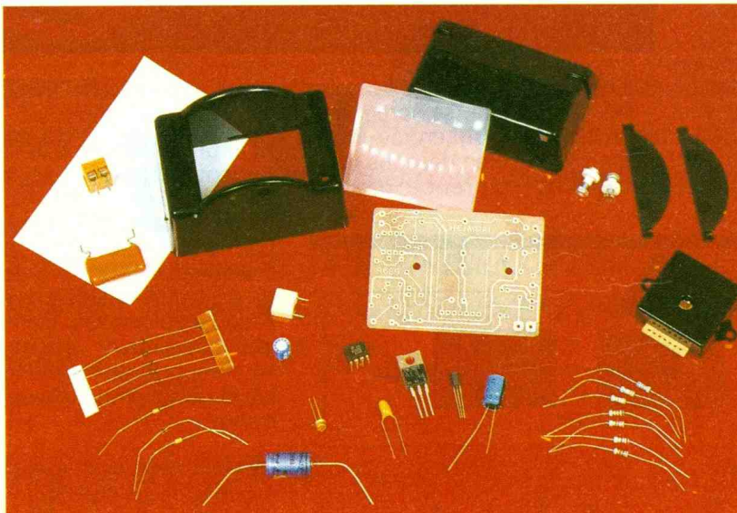
Photo 2. – Ensemble des composants du kit, comprenant le détecteur MS 02 infrarouge multizone.
