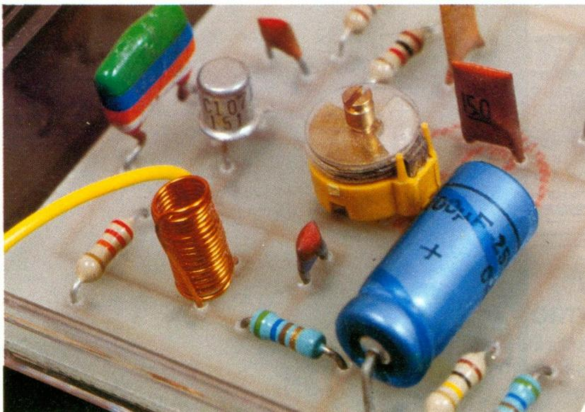
Photo 2. - L'étage haute fréquence avec le condensateur variable CV<sub>1</sub> et la bobine.
