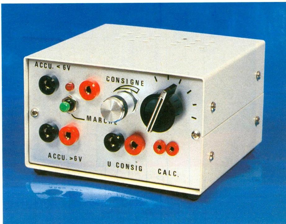
Au départ de la mesure, le potentiel présélectionné par P<sub>4</sub> commande les transistors T<sub>2</sub> et T<sub>3</sub> via le comparateur IC<sub>3</sub>. T<sub>2</sub> pilote la diode électroluminescente D<sub>8</sub> qui signale que le comparateur est au niveau haut. T<sub>3</sub> est également conducteur et l'amorçage du thy-
