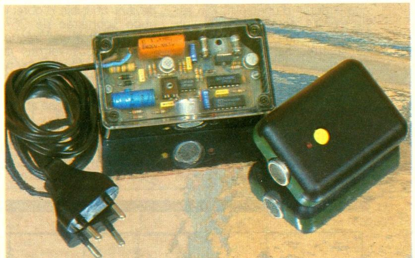
d'un transistor qui commande en définitive un triac d'utilisation. Ainsi, à chaque sollicitation du bouton-poussoir du boîtier-émetteur, on obtient alternativement
