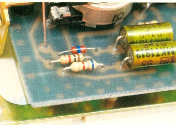
Photo 3. – Vue du circuit d'amorçage du Triac TR.
