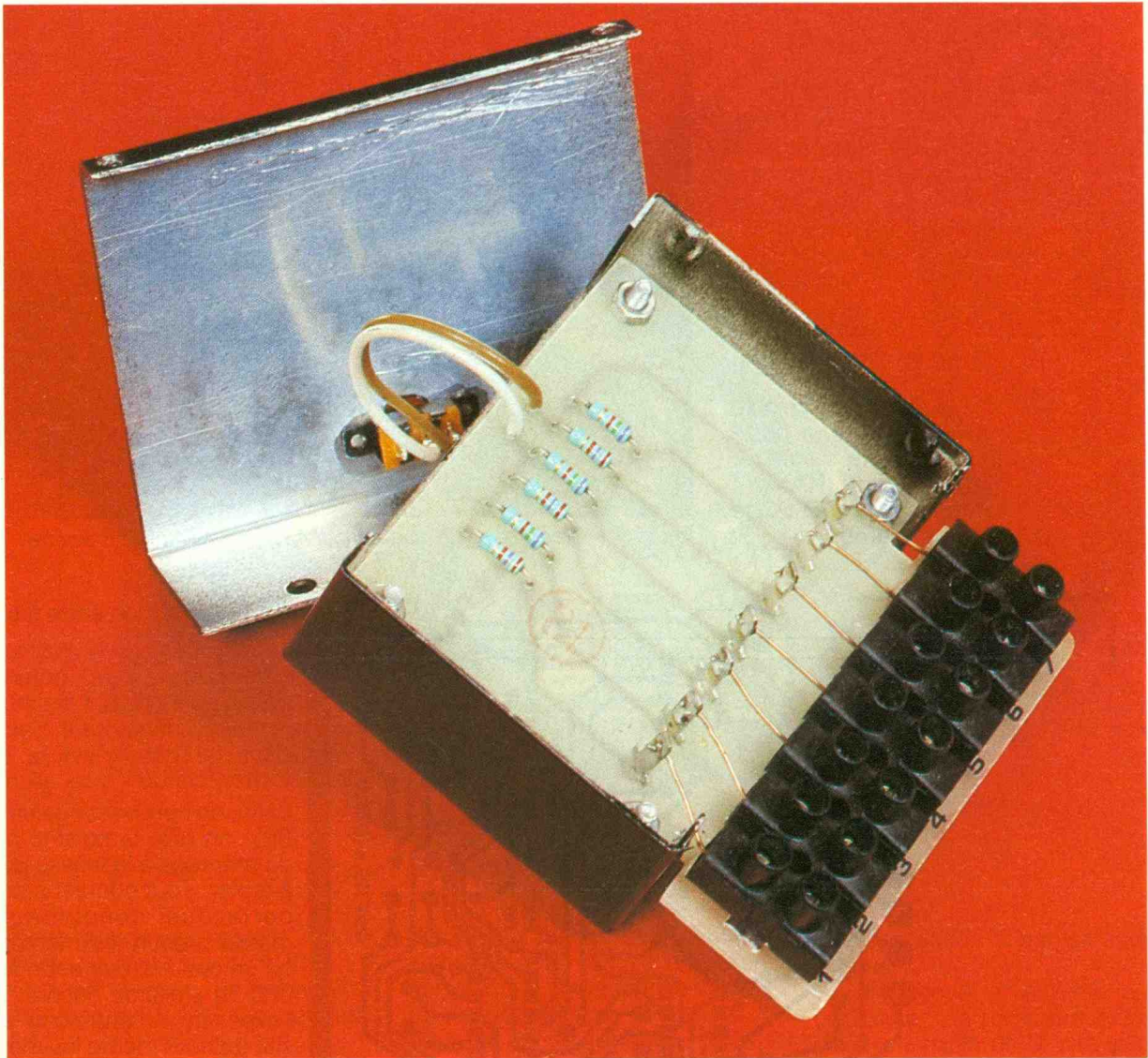
Photo 4. – L'autre boîtier ne renferme que des résistances.
