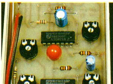
Photo 3. – En rouge, utilisation d'un condensateur tantalé.
