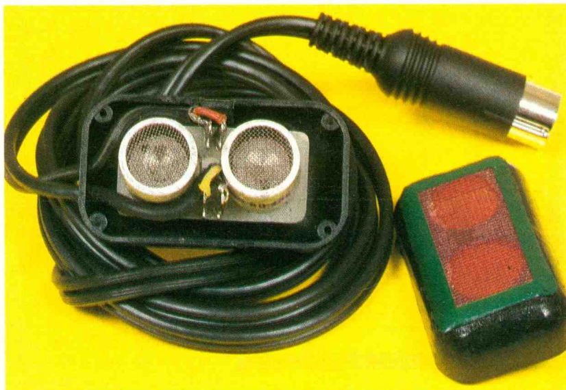
Photo 4. – Aspect du module transducteurs.
