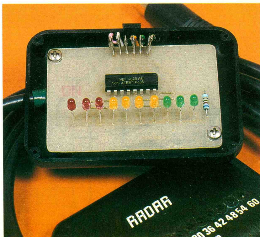
Photo 2. - Le boîtier d'affichage du radar.
