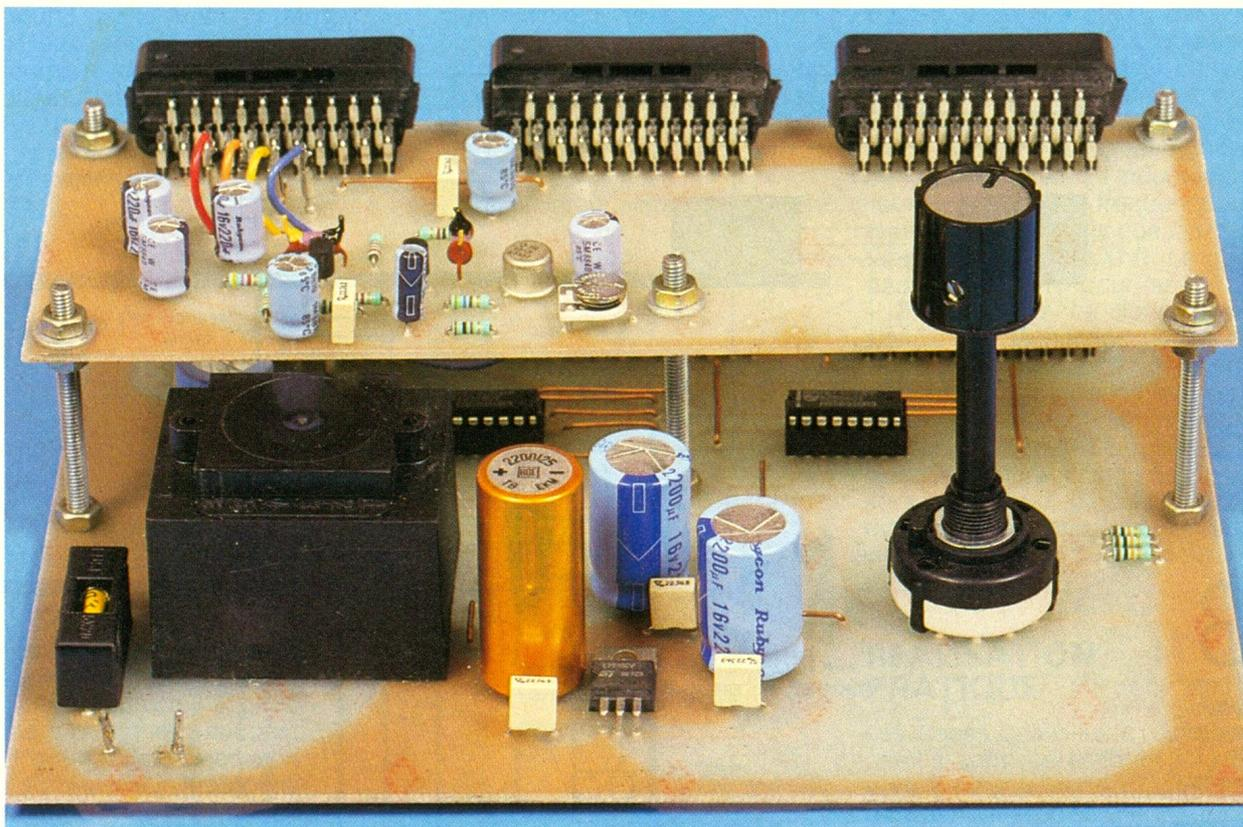
La solution consiste à utiliser un commutateur vidéo. Celui-ci comportera  $n$  entrées, ici trois, que l'on pourra aiguiller vers la sortie se connectant sur le téléviseur, maillon final de la chaîne.
