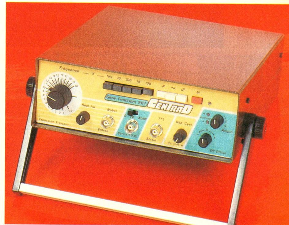
les triangles en dents de scie et les carrés en créneaux de rapport cyclique, ajustable entre 0 et 100 %.
