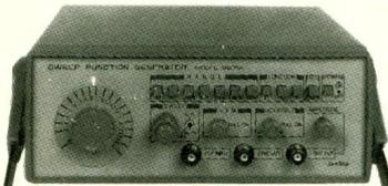
**G 205/8205 A.** Générateur de fonction de 0,02 Hz à 2 MHz en 7 calibres
