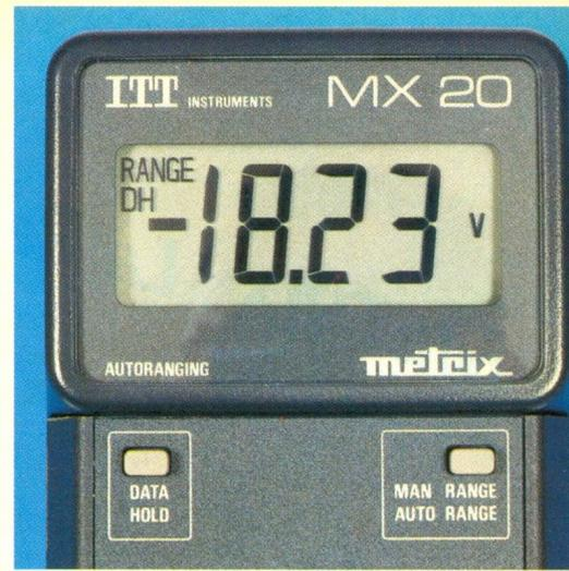
Photo 3. – L'affichage LCD utilise des segments de 17 mm.
