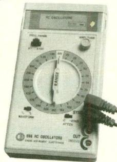
**555RC.** Générateur portable de 20 Hz échelonnées en 46 fréquences fixes. Sinus et carré. Atténuateur - 20 dB. Taux de distorsion à 15 kHz : 0,05 % à 150 kHz : 0,3 %.
