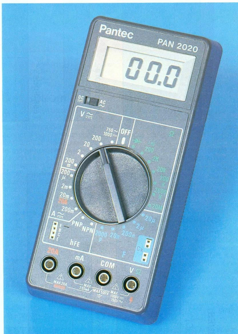
quatre bornes de sécurité dont deux particulières à l'ampèremètre. La première, protégée par un fusible, accompagne les calibres  $200\ \mu\text{A}$  à  $200\ \text{mA}$ . La seconde va de pair avec le calibre  $20\ \text{A}$ . A noter toutefois qu'elle ne dispose
