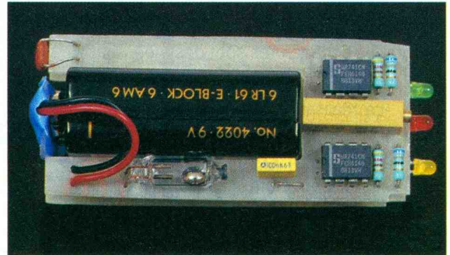
Photo 3. – On aperçoit l'ampoule de mercure.
