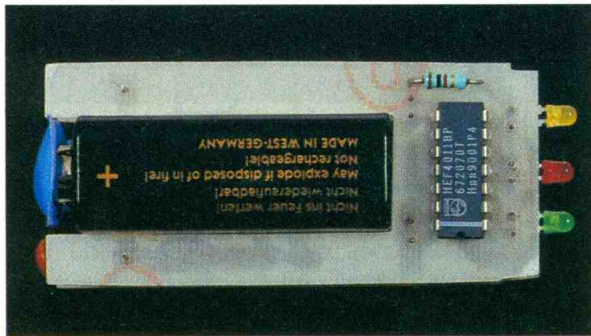
Photo 2. – La pile sera maintenue au centre des circuits imprimés.
