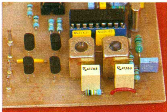
Photo 4. — Vue des transformateurs F.I.
