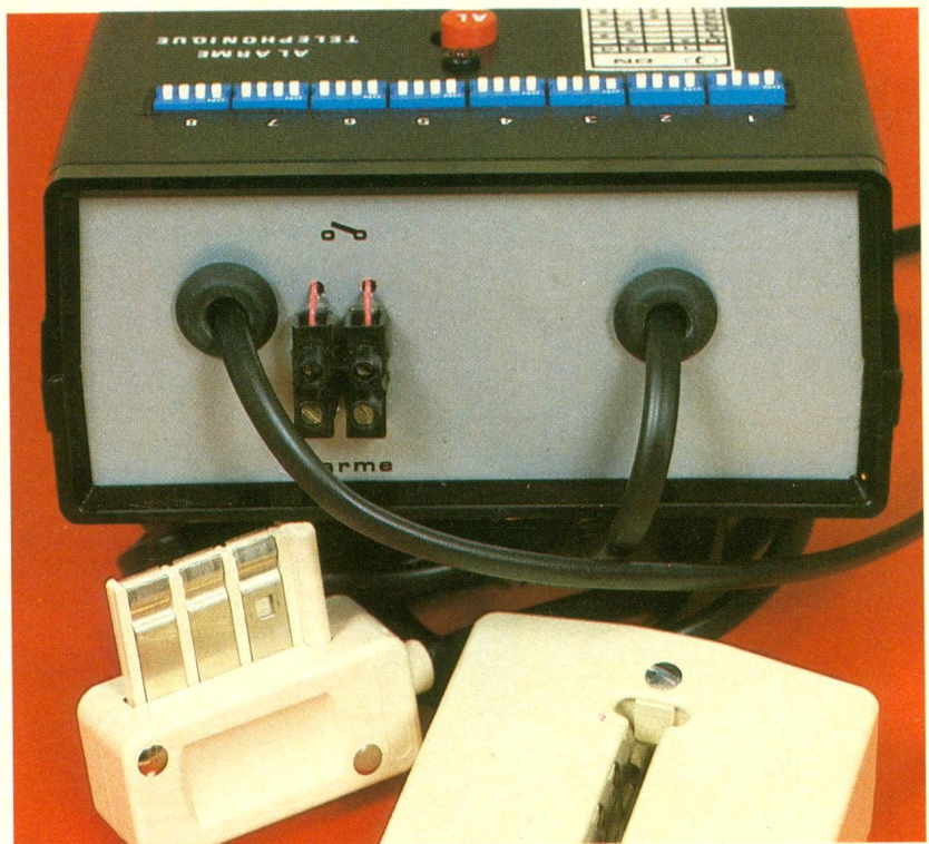
Photo 6. - Raccordements de la maquette vers l'extérieur.
