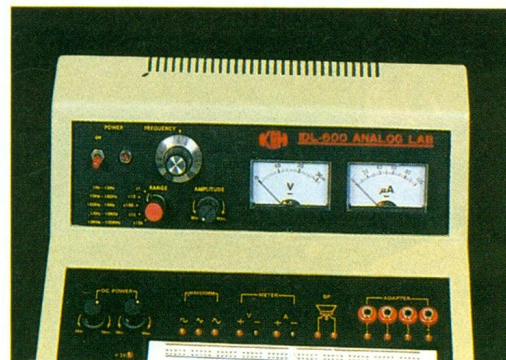
Photo 3. — Aperçu des deux galvanomètres mesurant la tension et le courant (V et \mu A).
