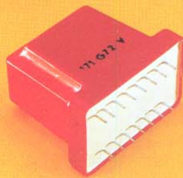
Transformator van de nieuwe „Switch-Mode” netvoeding.
