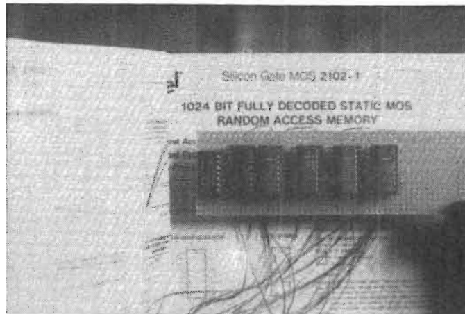
Fig. 5 - Circuit « appendice » des mémoires 2102.
