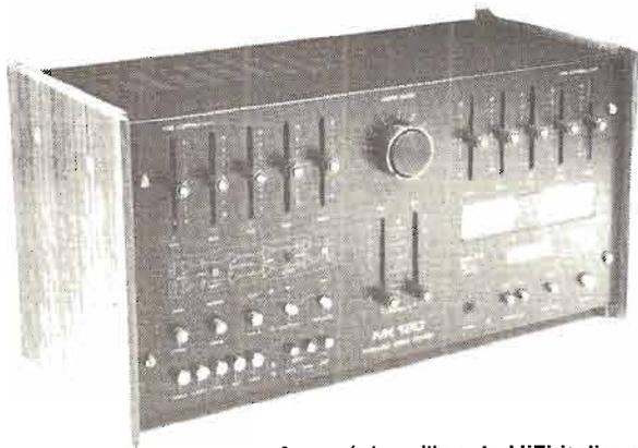
Autre échantillon de HiFi italienne : le MK 120 de Galactron. 2 fois 70 W sur 8 ohms, indication de surcharge sur chaque étage.
