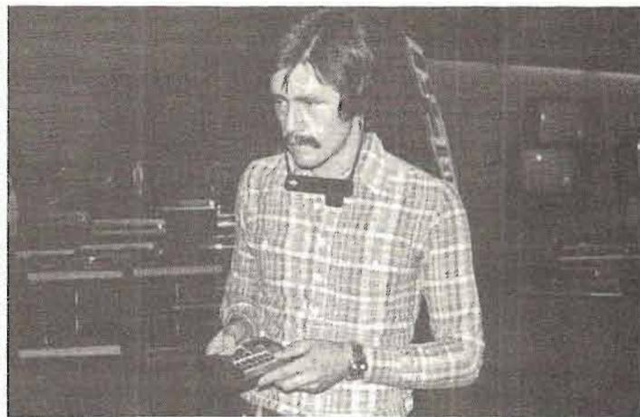
Photo 2. - Récepteur de son infrarouges et boîtier de télécommande (système Sennheiser).
