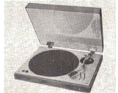
Cette nouvelle platine Akai possède un système automatique d'arrêt et de retour du bras, en fin de disque mais qui peut être obtenu en cours de disque par pression sur le levier « cut ». La mise en route du plateau est obtenue dès que le bras de P.U. est soulevé. L'entraînement du plateau est effectué par courroie, le moteur est un synchrone à 4 pôles.
