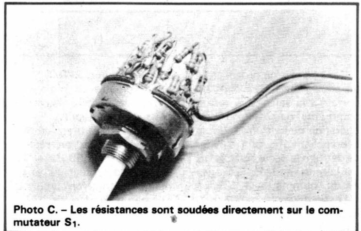
Photo C. - Les résistances sont soudées directement sur le commutateur  $S_1$ .
