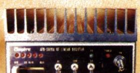
Ampli HF mobile 26 à 30 MHz « Ampère 100 », 100 W AM, 200 W SSB, modulation réglable et contrôle par LED, ampli réception incorporé.
