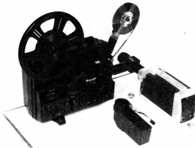
défilement du projecteur (18 ou 24 im./sec.) avec la vitesse d'analyse de la caméra (25 im./sec. en SECAM).
