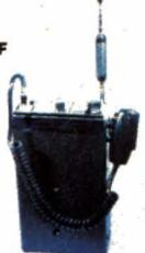
Tranceiver CB portable AM 4 W, SSB 12 W, batteries cad. recharge incorporée, 40 ch, utilisation possible en base fixe.
