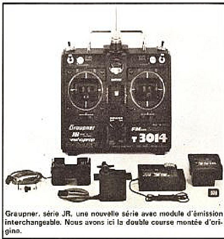
Graupner, série JR, une nouvelle série avec module d'émission interchangeable. Nous avons ici la double course montée d'origine.
