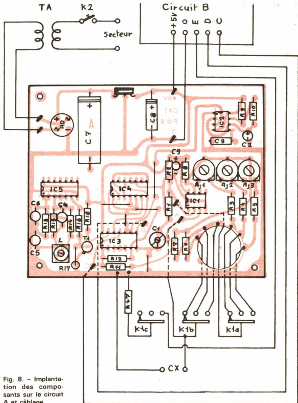
Fig. 8. - Implantation des composants sur le circuit A et câblage.
