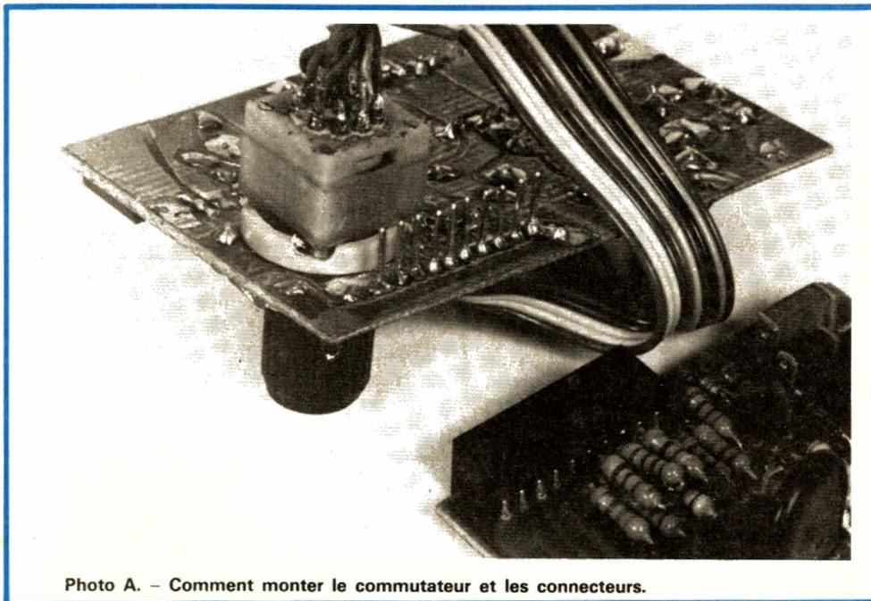
Photo A. - Comment monter le commutateur et les connecteurs.
