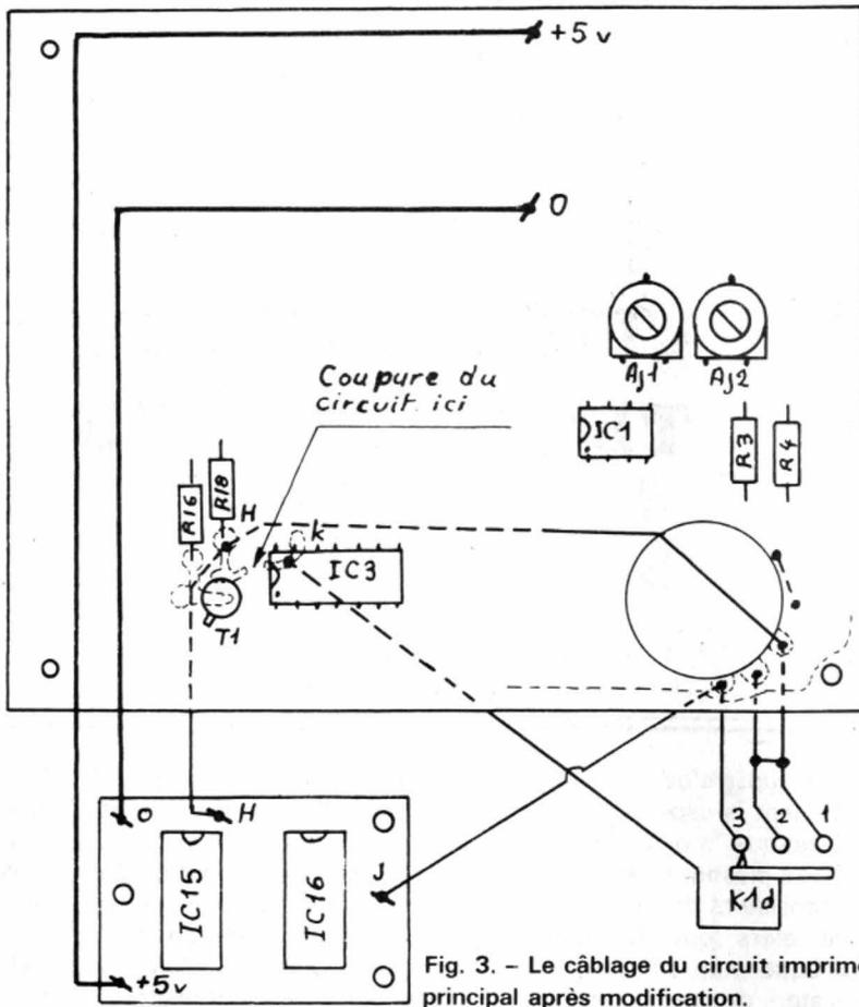
Fig. 3. - Le câblage du circuit imprimé principal après modification.
