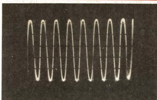
Photo 7. - Oscillogramme relevé à la sortie de IC5 ;  $f = 1\text{ MHz}$ ,  $IV_{CC}/div$ ,  $I\mu s/div$ .
