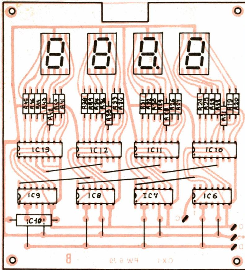
Fig. 9. - Implantation des composants sur le circuit B.
