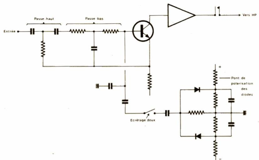
Fig. 1. - Principe de l'écrêtage « doux » et filtre d'entrée du second ordre.
