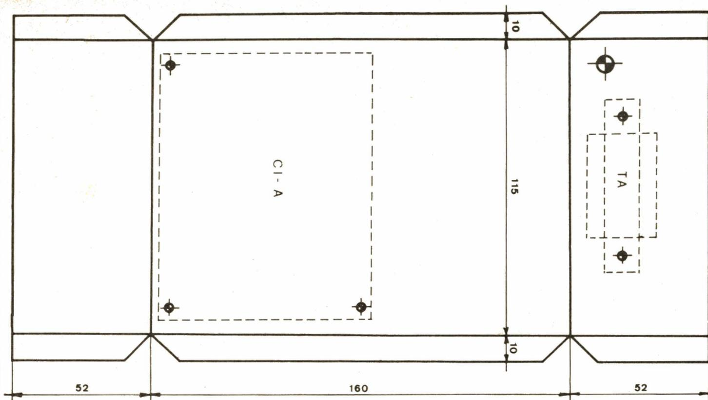
Fig. 10. - Le boîtier, tôle d'aluminium de 10/10<sup>e</sup>, pliages vers l'arrière, trous marqués à percer suivant la visserie et le matériel utilisé.
