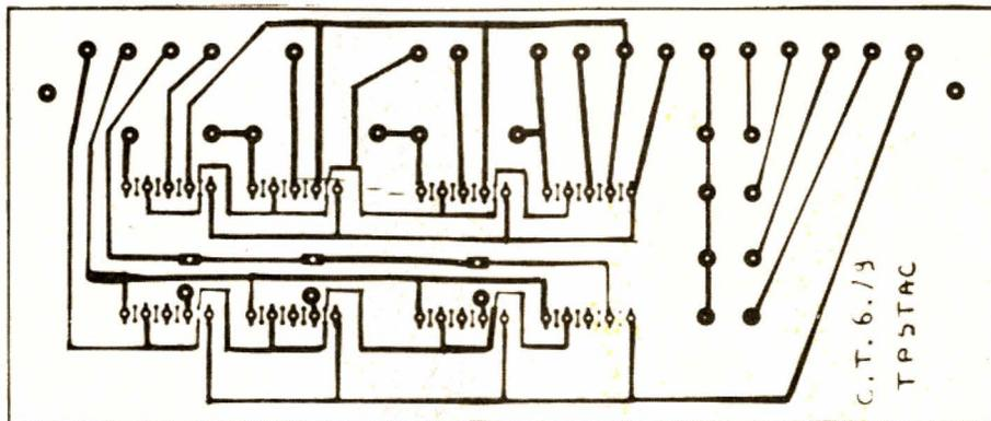
Fig. 3. - Dessin du CI des afficheurs simple (échelle 1).
