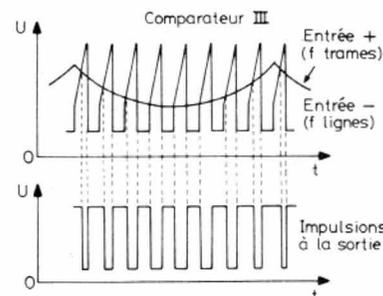
Fig. 12. - Formation des impulsions à largeur variable pour  $Th_3$ .
