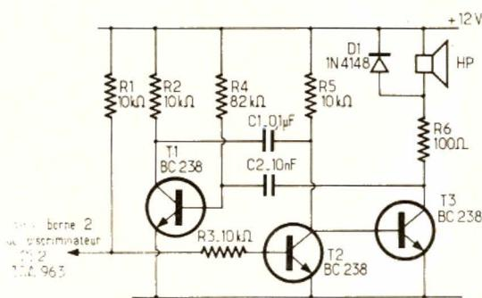
Fig. 9. - Schéma d'un avertisseur sonore.
