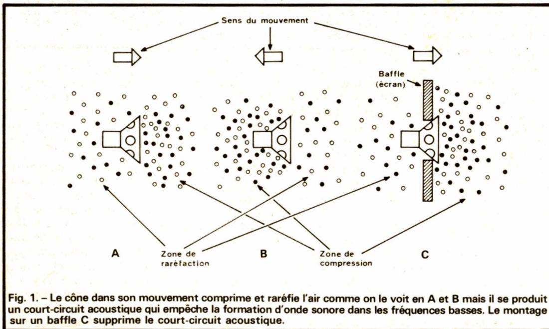
Fig. 1. - Le cône dans son mouvement comprime et raréfie l'air comme on le voit en A et B mais il se produit un court-circuit acoustique qui empêche la formation d'onde sonore dans les fréquences basses. Le montage sur un baffle C supprime le court-circuit acoustique.
