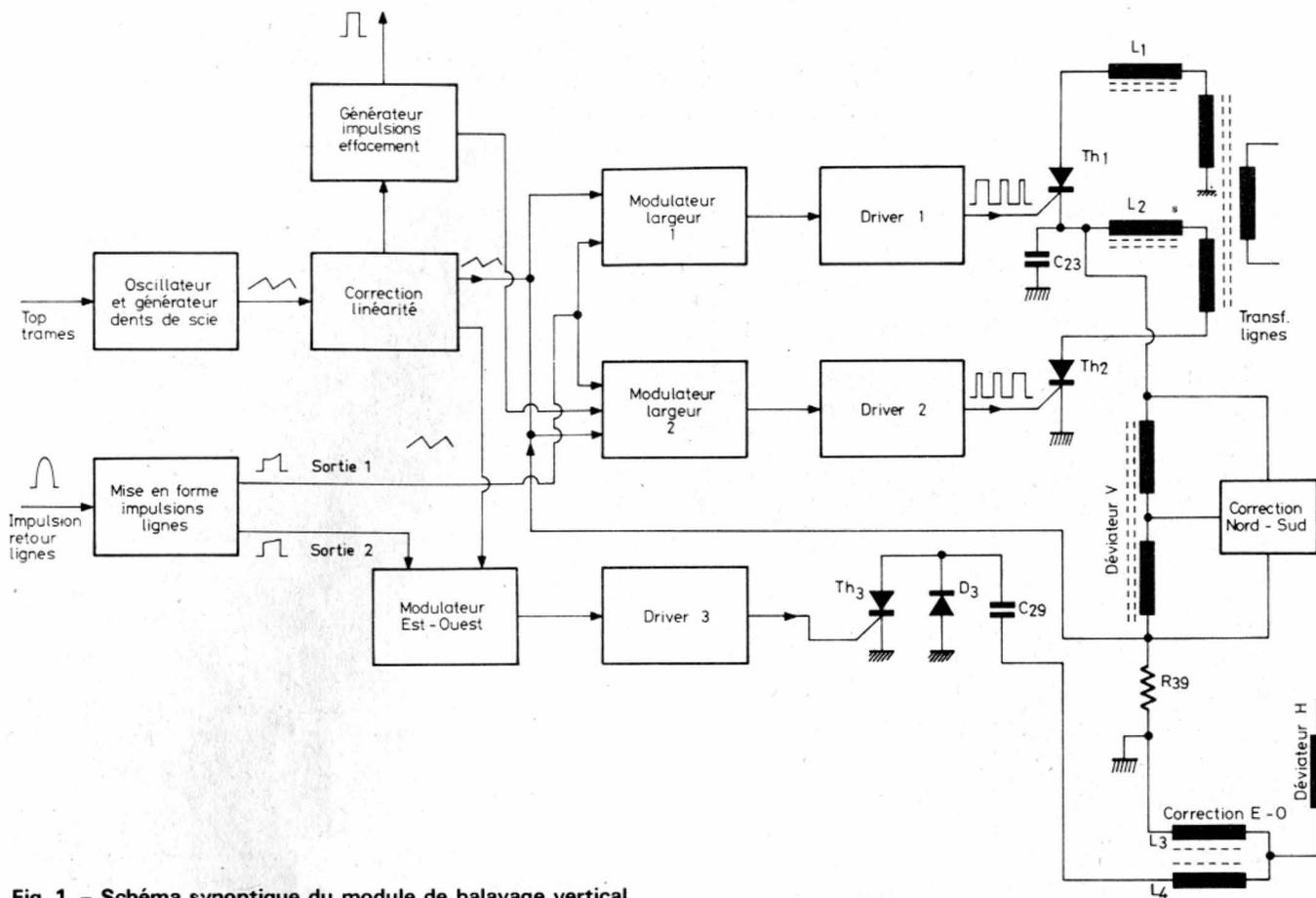
Fig. 1. - Schéma synoptique du module de balayage vertical.
