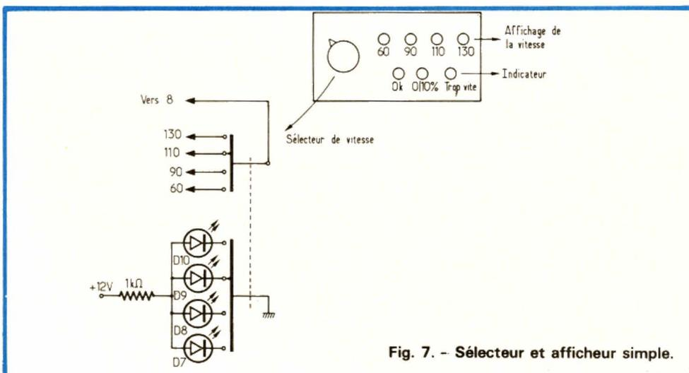
Fig. 7. - Sélecteur et afficheur simple.
