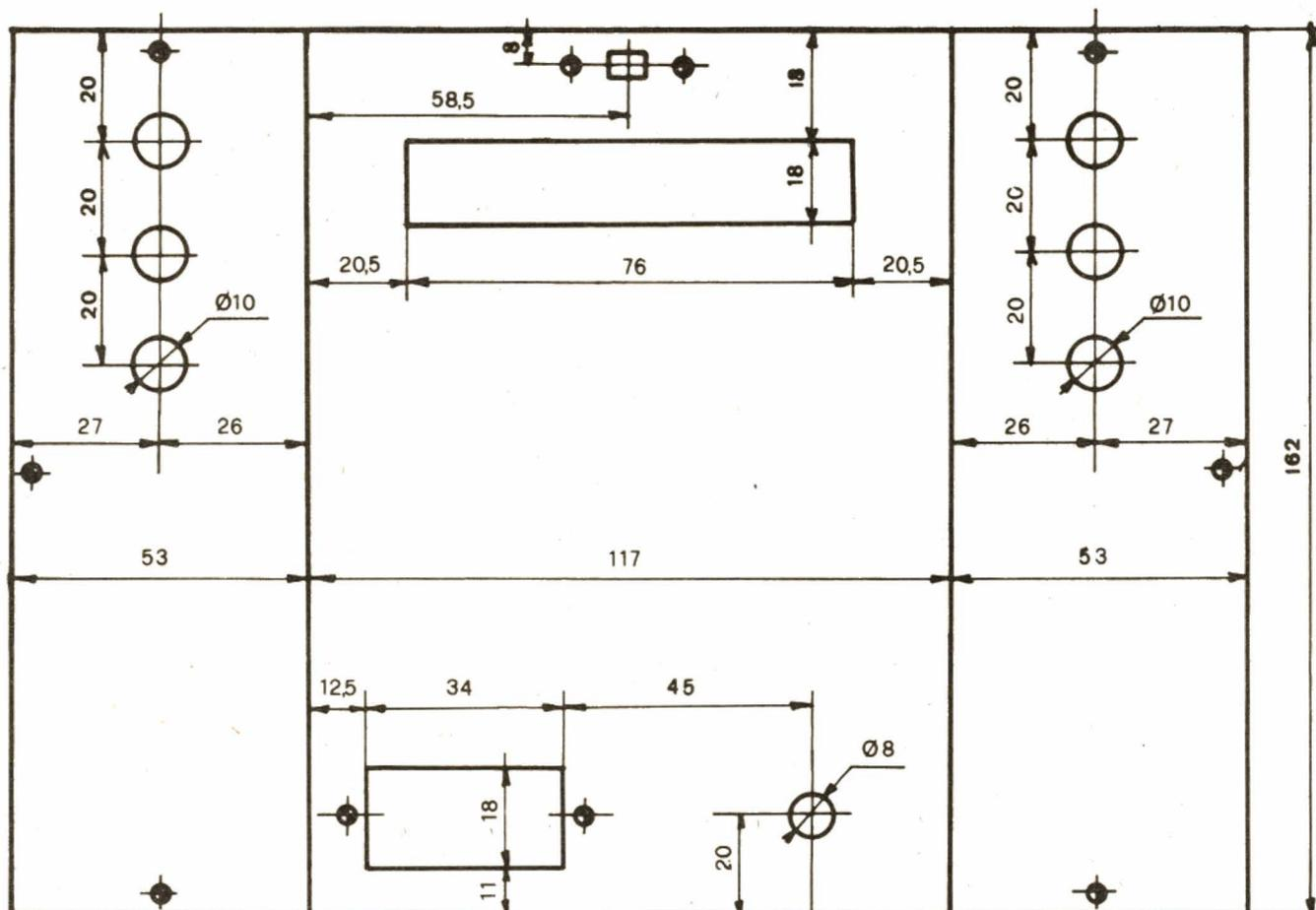
Fig. 11. - Le couvercle, tôle d'aluminium de 10/10<sup>e</sup>, pliage vers l'arrière.
