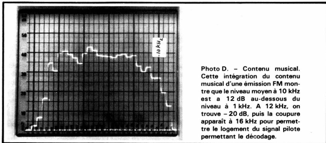
Photo D. - Contenu musical. Cette intégration du contenu musical d'une émission FM montre que le niveau moyen à 10 kHz est à 12 dB au-dessous du niveau à 1 kHz. A 12 kHz, on trouve -20 dB, puis la coupure apparaît à 16 kHz pour permettre le logement du signal pilote permettant le décodage.
