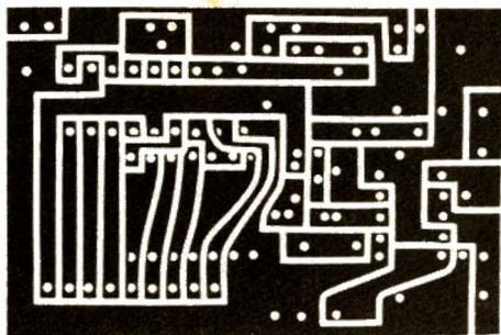
Fig. 11. - Circuit de mesure, gravure anglaise.
