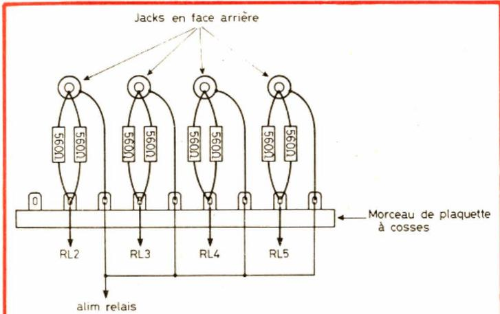
Fig. 17. - Câblage des prises de relais.
