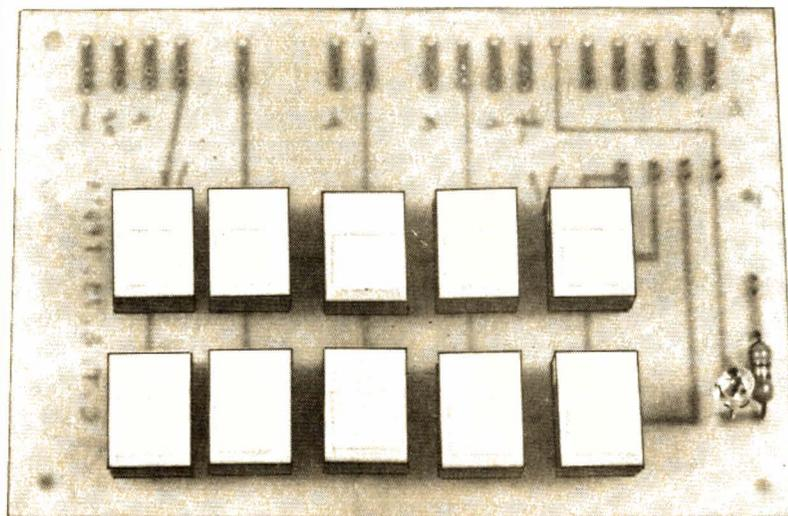
Photo A. - Le circuit imprimé du clavier. Essayez de faire mieux que l'auteur pour l'alignement des touches!
