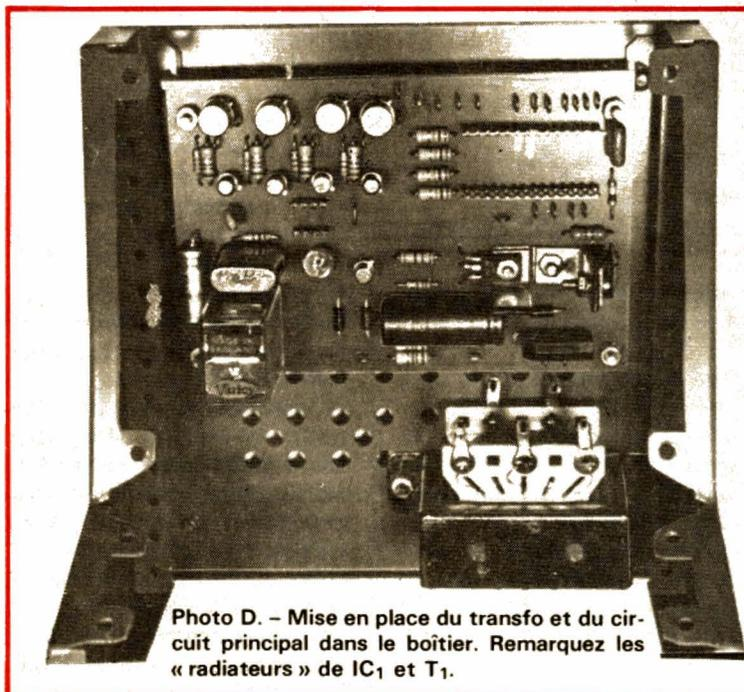
Photo D. - Mise en place du transfo et du circuit principal dans le boîtier. Remarquez les « radiateurs » de  $IC_1$  et  $T_1$ .
