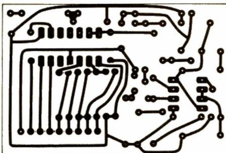
Fig. 11 bis. - Circuit de mesure, gravure classique.
