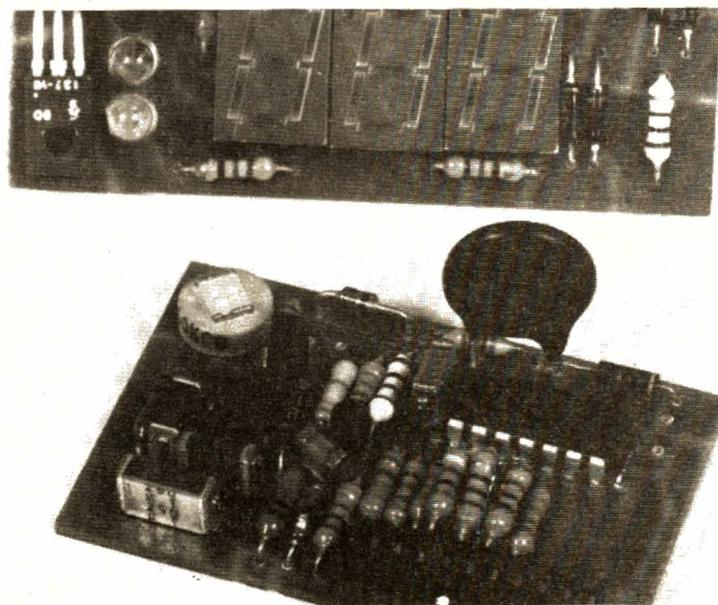
Photo B. - Le circuit de mesure et son connecteur.
