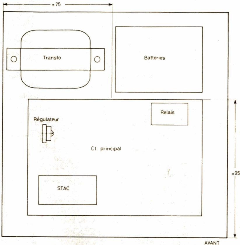
Fig. 11. - Disposition interne en fond de boîtier.
