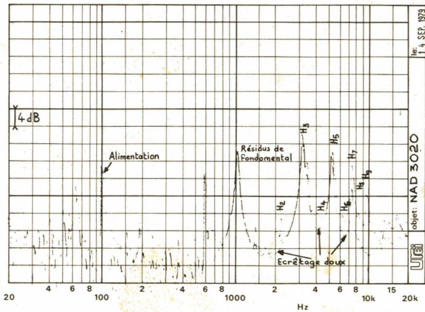
Courbe C. - Spectre de distorsion avec et sans écrêtage doux, après passage dans un filtre réjecteur.
