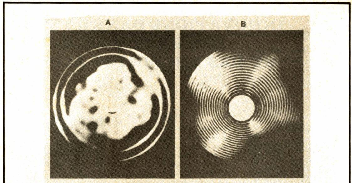
Fig. 2. - Une analyse holographique réalisée sur un haut-parleur de 20 cm montre que la membrane se déforme à partir de 2 000 Hz (voir tableau des longueurs d'ondes acoustiques) à 9 000 Hz les déformations couvrent l'ensemble de la membrane.
