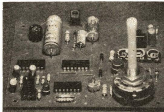
Photo 1. - Le circuit A est câblé, la disposition des composants est ordonnée. L'alimentation vue ici nous a causé quelques déboires, nous l'avons remplacée par un régulateur intégré.
