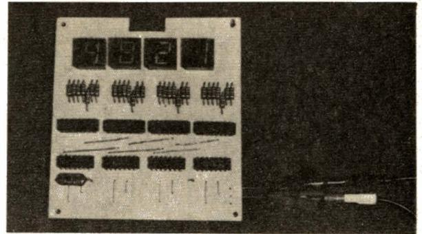
Photo 3. - Le circuit B est câblé, notez la parfaite disposition des composants obtenue malgré l'emploi d'un circuit imprimé à simple face.
