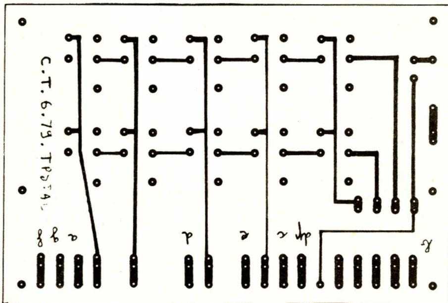
Fig. 2. - Plan d'implantation du CI du clavier.
