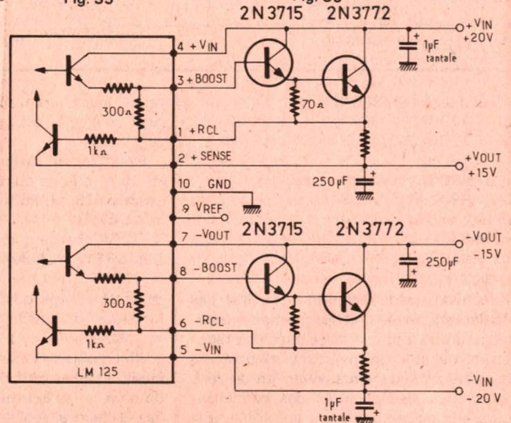
Afin de limiter le courant de sortie, il faut insérer une résistance  $R_{CL}$  dont le rôle est de permettre la mesure du courant de charge à tout moment, ainsi le régulateur se bloquera dès que la tension sur les bornes de  $R_{CL}$  atteindra la valeur du seuil déterminé figure 34.
