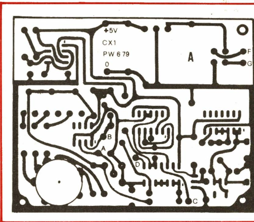
Fig. 6. - Le circuit A, l'utilisation des symboles à transfert direct ou de la méthode photo est indispensable vu la relative complexité du tracé.
