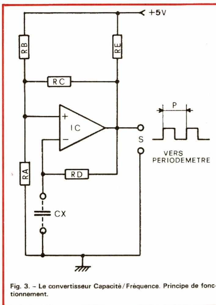
Fig. 3. - Le convertisseur Capacité/Fréquence. Principe de fonctionnement.
