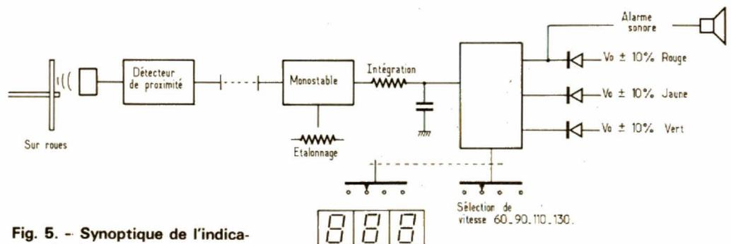
Fig. 5. - Synoptique de l'indicateur de vitesse.
