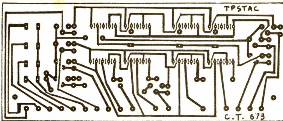
Fig. 6. - Dessin du CI d'afficheurs à amplificateurs (échelle 1).
