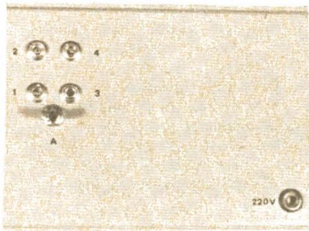
Photo H. - La face arrière supporte les 4 jacks et l'interrupteur des batteries.
