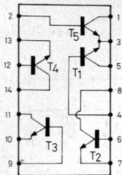
Fig. 3. - Structure interne du circuit intégré TCA871.
