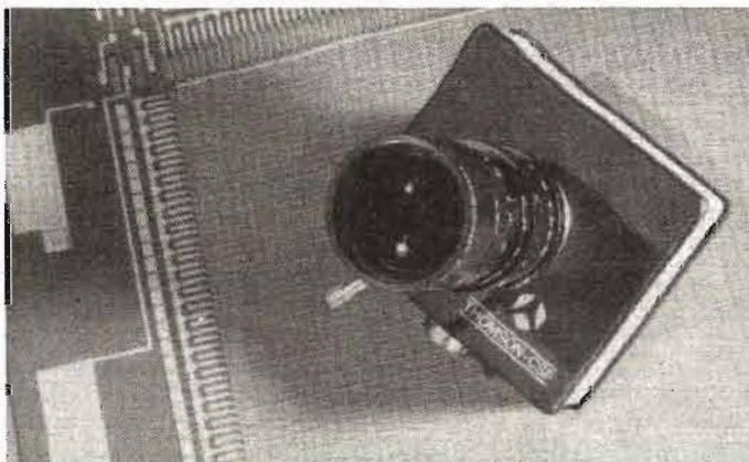
Fig. 1 - Caméra TV miniature et circuit à transfert de charge.
