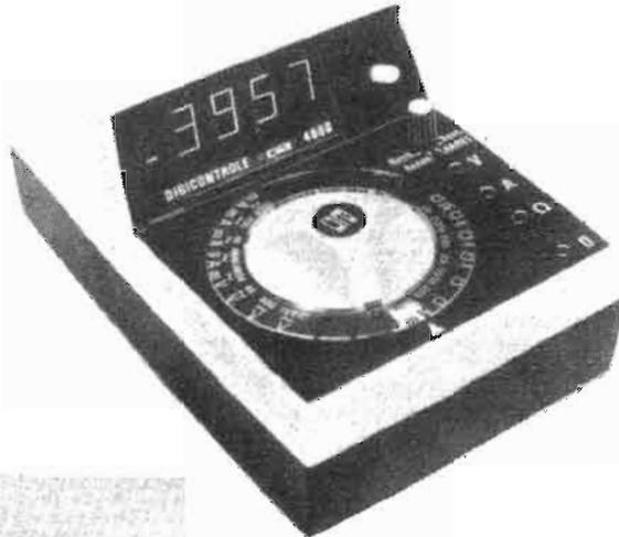
Fig. 7 - Multimètre numérique CDA 400 Chauvin Arno.
