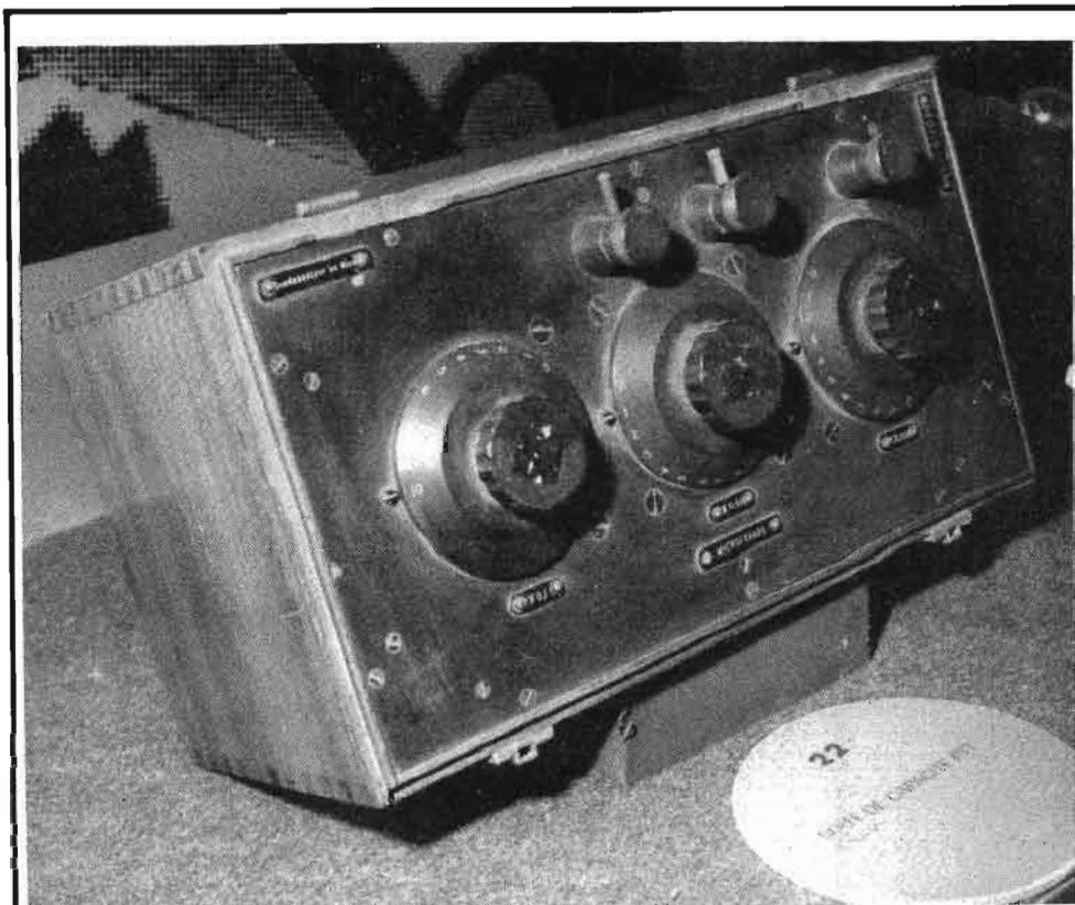
Photo 5. - Boîte de capacité P.T.T. Les photographies qui illustrent cet article nous ont été communiquées par le SIERE et représentent des appareils prêtés par le C.N.A.M. à l'occasion du cinquantième salon des composants électroniques.
