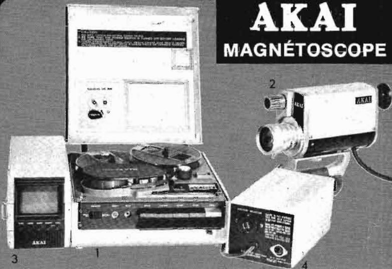
**Ensemble Akai VT 100 S.** 1) Magnéscope portatif (compteur, arrêt sur l'image, réglage de compatibilité d'une prise micro supplémentaire). 2) Caméra (visée reflex, zoom 10-40 mm/x 4). 3) Moniteur (écran 7,5 cm) 2 accus rechargeables et chargeur.
