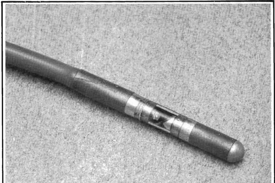
Photo 1 - Ce cigare est une caméra de télévision subminiature, son diamètre n'est que de 4,5 mm. Au milieu, on aperçoit la fenêtre de l'objectif. L'ensemble est relié à une gaine souple que l'on voit à la gauche du document.
