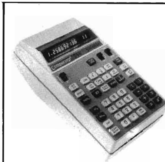
Photo 3 - Le micro-calculateur statistique programmable COMPUCORP.
