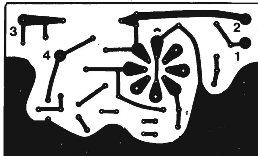
Fig. 7 - Représentation à l'échelle 1/1 du circuit imprimé. Ce dernier est vu de l'arrière, côté cuivre, les zones sombres indiquant le métal qui doit subsister après l'attaque chimique.
