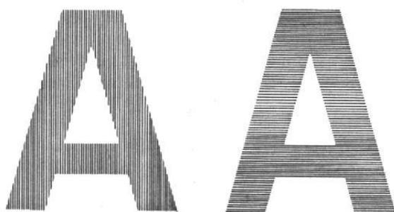
*La composition photo-électronique de texte, diagrammes, dessins, etc.. à reproduire, se résume : 1°) à faire tracer par un faisceau d'électrons, sur un écran du type télévision, verticalement ou horizontalement, des lignes si fines et si rapprochées qu'elles donnent l'illusion du plein; 2°) d'enregistrer les tracés sur film photographique à une vitesse pouvant atteindre 10 000 caractères par seconde.*
