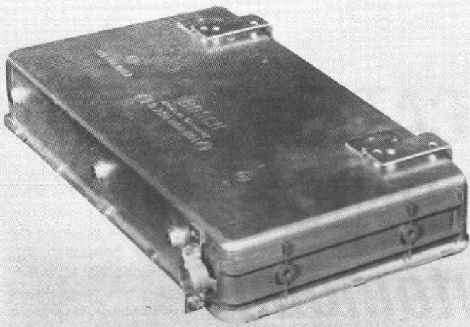
Fig. 1. — Le système électronique de commande du dispositif d'injection monté sur la voiture de tourisme Volkswagen VW 1600.
