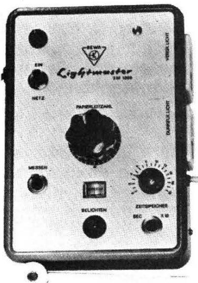
La firme allemande Wallner (représentée en France par Francclair), a lancé sur le marché un nouveau posemètre d'agrandissement, le Lightmaster Automatic. Sa cellule sensible au sulfure de cadmium se monte directement sur le margeur de l'agrandisseur et commande automatiquement, lors de l'exposition, le temps d'illumination en fonction de l'éclairement reçu. [12]
