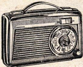
PO-GO : 6 transistors + diode.
