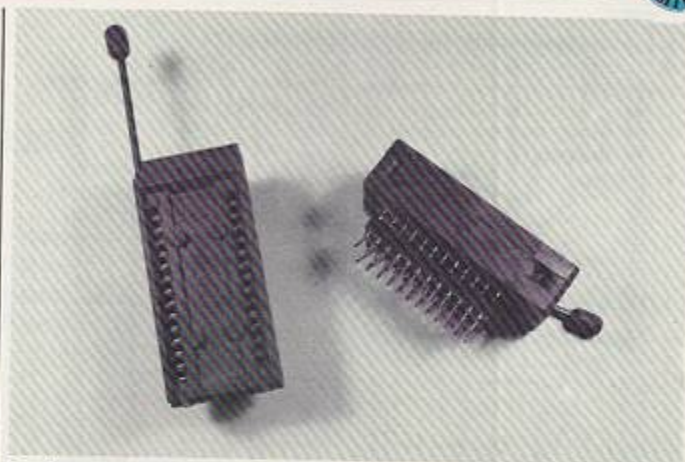
Les deux supports, 28 et 24 pattes, à force d'insertion nulle.
