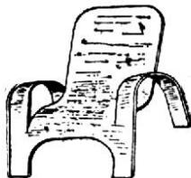
Fig. 2. — Fauteuil façonné et collé en 9 minutes avec un générateur HF de 6 kW.
