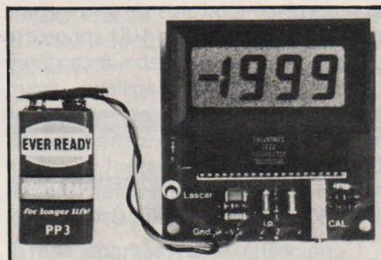
La calibration se fait au moyen d'un potentiomètre ajustable 20 tours monté sur le circuit imprimé. Le dépassement de capacité est indiqué par l'extinction des trois derniers digits. Le point décimal est programmable et l'impédance d'entrée est de 10 M $\Omega$ .
