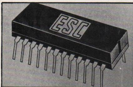
Il existe trois modèles de bases: LP50, LP100 et LP250 qui ont un retard maximal respectivement de 50, 100 et 250 nanosecondes en 5 incréments égaux. Toutefois, sur demande ESC peut fournir tout autre temps de retard. On peut noter que dans tous les cas le temps de montée maximal est de 8 nanosecondes.
