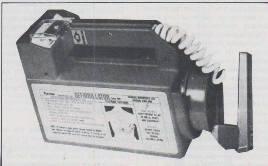
Fig. 6. - Photographie d'un défibrillateur portable d'urgence (document de l'importateur : Sarem à Strasbourg).
