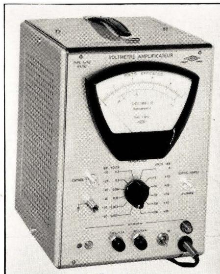
Voltmètre électronique A 403, pour tensions alternatives de 0,1 mV à 300 V (FERISOL).
