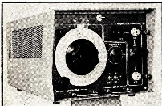
Générateur de signaux sinusoïdaux 2 Hz à 2 MHz, type GBF-2 A (ELA).
