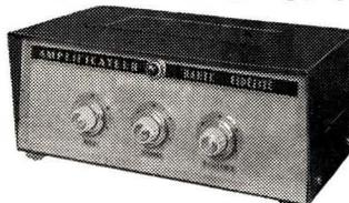
Push-pull 5 lampes, 3 entrées : Micro haute impédance, sensibilité 5 mV PU haute impédance, sensibilité 300 mV, PU haute impédance, sensibilité 10 mV. Taux de distorsion : 2 % à 7 W. Réponse droite + 1,5 dB de 30 à 15 000 c/s. Impédances de sortie : 2,5, 4 et 8 ohms. 2 réglages de tonalités : graves et aiguës. Fonctionne sur secteur alternatif 110/220 V. Présentation professionnelle. Coffret ajouré. Dim. 220 x 155 x 105 mm
